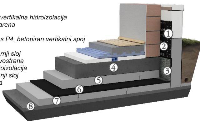
Posipana strana je okrenuta prema budućoj AB ploči, kako bi svježi beton pri betoniranju prionuo na grubi posip. Naknadno, prije izrade fasade, na hidroizolacijski spoj se stavlja vertikalna hidroizolacija u zoni sokla koja se izvodi na klasičan način sa Izoelast P4 plus trakom za zavarivanje.
