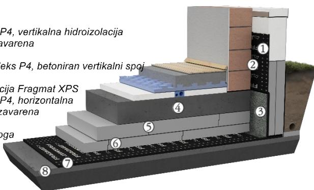
Vrlo slično rješenje koristi se i kod izvedbe Hidroproof sustava ukopanih objekata na slabo dreniranim i podzemnim vodama opterećenim terenima, samo što je obavezna dvoslojna hidroizolacija za koju koristimo vrlo otporne polimer bitumenske trake ojačane poliesterskim filcom, na primjer Izotekt P4 plus ili Izotelast P4 plus.
